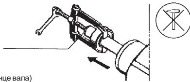
Auf- und Abziehen von Abtriebselementen / Pressing on and pulling off drive elements / Emmanchement et extraction d'organes de transmission / Calado y extracción de elementos de accionamiento / Calettamento ed estrazione degli elementi di azionamento / På- och avdragning av drivdon / Nasazování a stahování přenosových členů / Установка и стягивание элементов передачи
