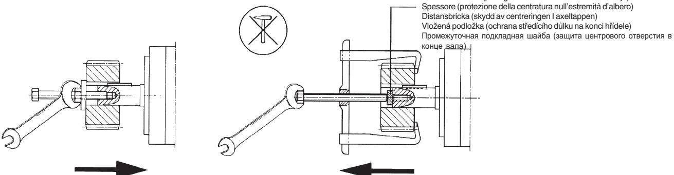
Zum Aufziehen von Abtriebselementen (Kupplung, Zahnrad, Riemenscheibe usw.), Gewinde im Wellenende benutzen und - sofern möglich - Abtriebselemente nach Bedarf erwärmen. Zum Abziehen geeignete Vorrichtung verwenden. Es dürfen beim Auf- und Abziehen keine Schläge (z.B. mit Hammer oder ähnlichem) oder größere als die laut Katalog zulässigen radialen oder axialen Kräfte über das Wellenende auf die Motorlager übertragen werden.
